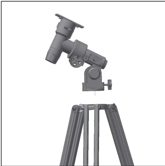
Abb. 4. Einbau der äquatorialen Montierung.
