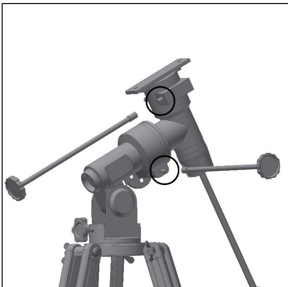
Abb. 6. Anbringung der Feinjustierschrauben.
